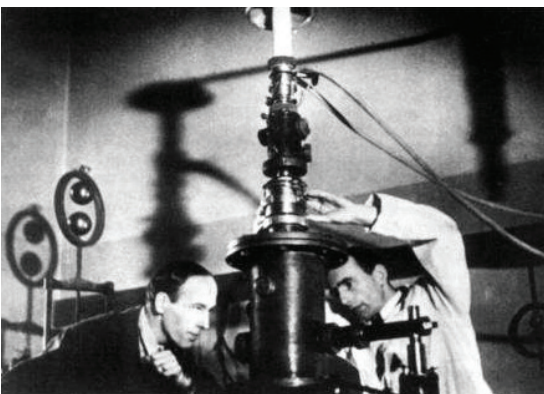
Deux chercheurs et le premier microscope électronique (à droite Ernst RUSKA, frère d'Helmut et prix Nobel de Physique en 1986)
