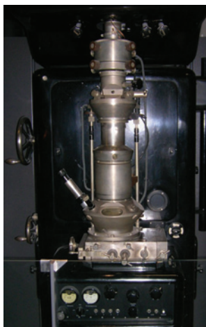
Réplique du premier microscope électronique construit par Ernst RUSKA en 1933
