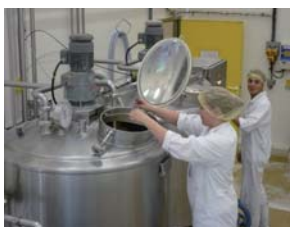
Fabrication du yaourt : ajout des bactéries spécifiques (Photo : ÉNILBIO de Poligny, Jura)
